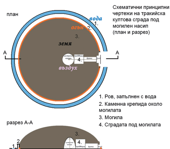
Обр. 7. Схематичен план и разрез на тракийска култова сграда под могилни насип, автор: А. Сърбова
