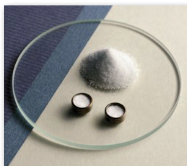
Фиг. 3. TL материал: TLD-100 – вляво, и полиетиленови капсули – вдясно
