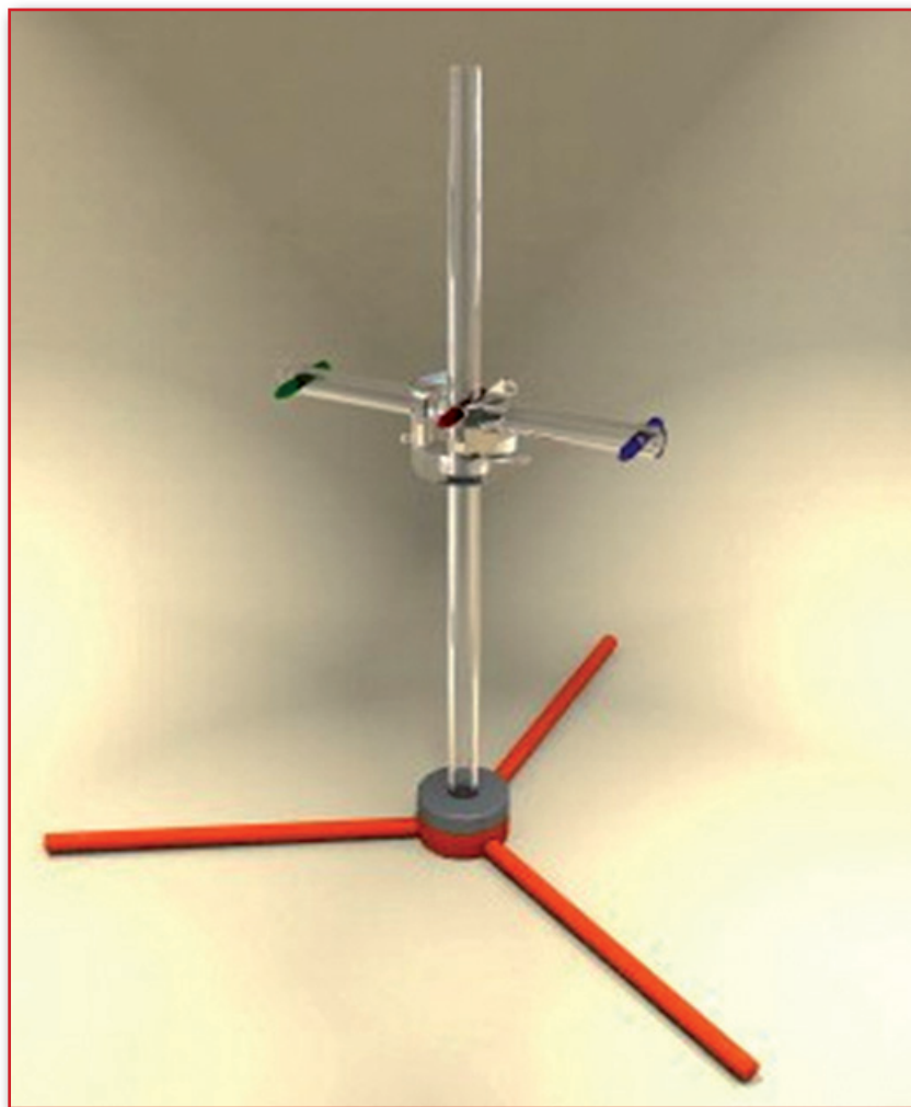
Фиг. 8. Новият държател за термолуминесцентни дозиметри на МААЕ
